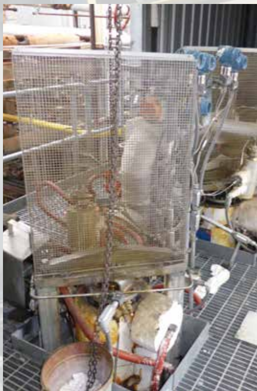
Filtrazione di resina naturale a 275°C, 300 µm ottenuta con elementi di filtrazione definiti
