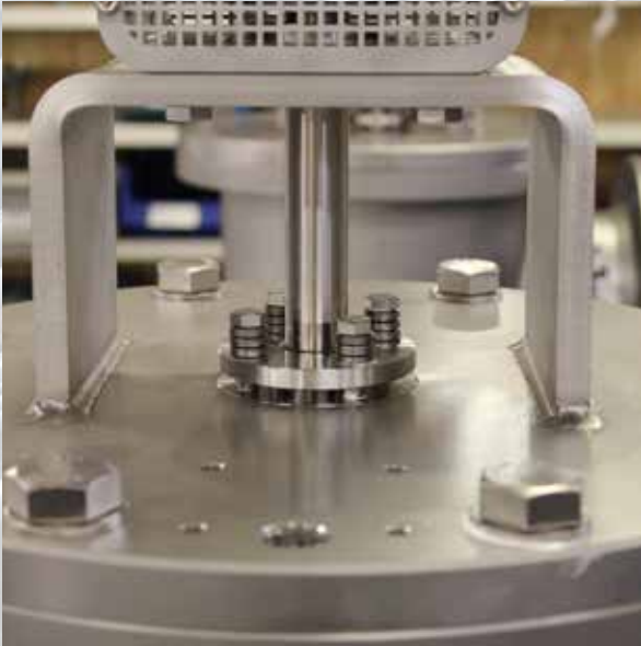
Sistema di tenuta ermetico mediante pressione a molla
