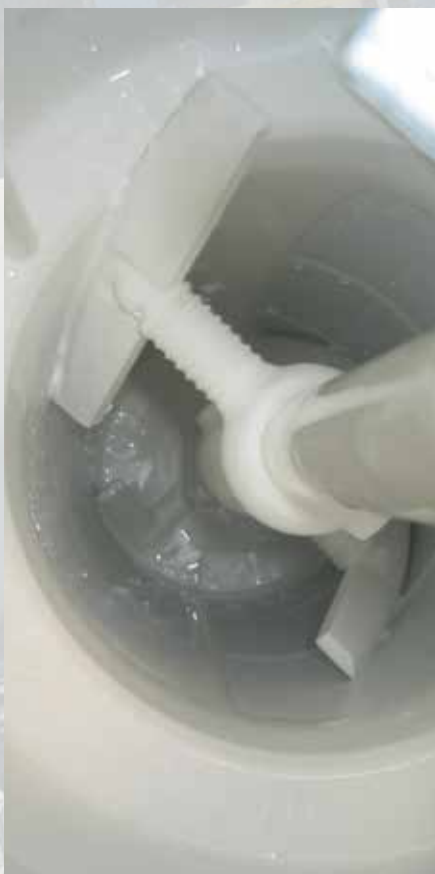
Sistema di pulizia a spatole rotanti
