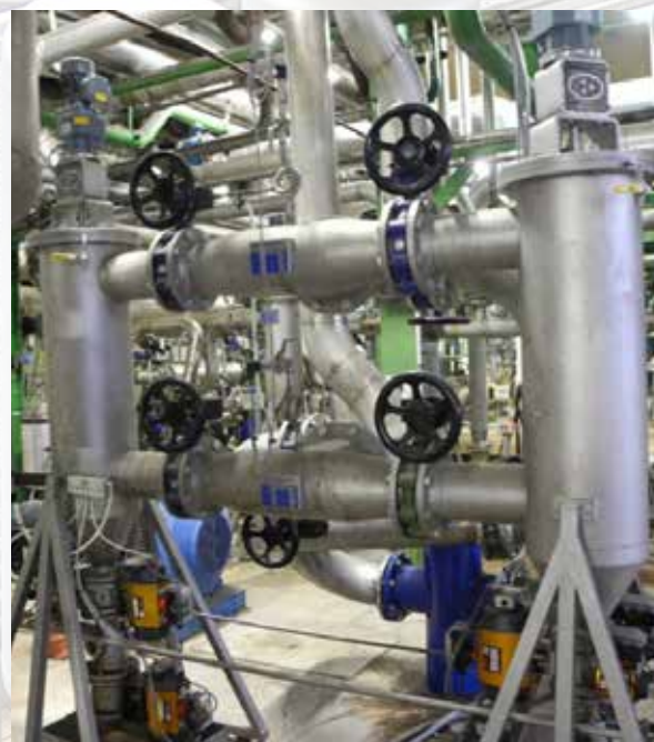
2 pz. di Auto-line® XXLR-E per la filtrazione dello sciroppo dalle barbabietole da zucchero
