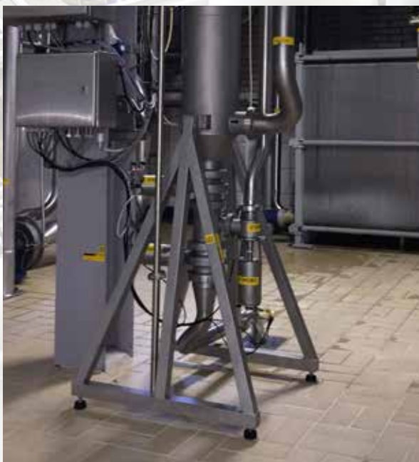
Auto-line® LE per la filtrazione di siero di latte in un caseificio
