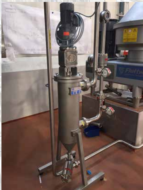
Auto-line® LR-E per la filtrazione di acqua gelatinosa
