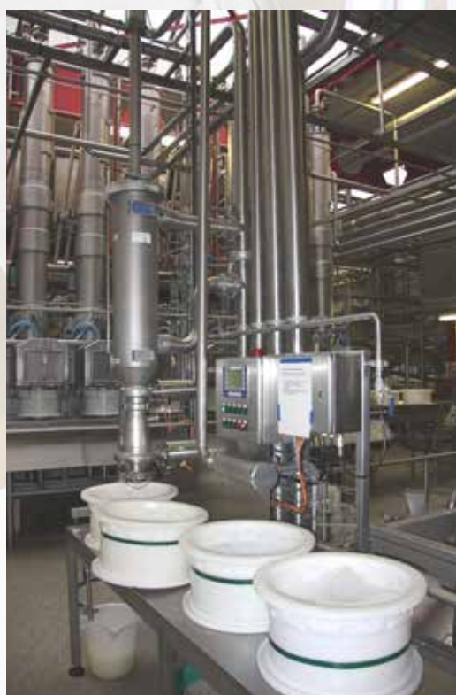
Auto-line® XLE per la filtrazione di particelle di cagliata dal siero di latte dopo la formazione del formaggio
